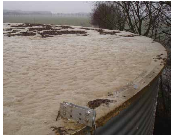
Alzchem Trostberg GmbH Gülleprobleme wie Schaum- oder Schwimmschichtbildung haben ihre Ursache in der Methan-Bildung der Gülle.
